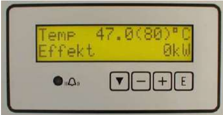
30-trinns elektronisk regulator med mulighet for fjernstyring
